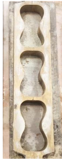
شکل ۴-الف: قالب ساخت نمونه های بریکت (پاپیونی)
