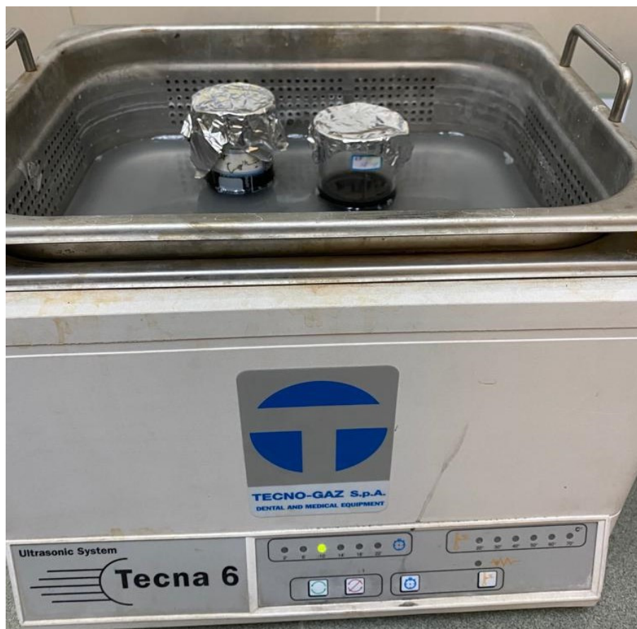
تصویر (۱): تهیه محلول گرافن اکساید توسط دستگاه اولتراسونیک
