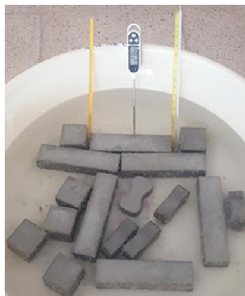
شکل ۱- ب: کنترل دمای آب برای عمل آوری
