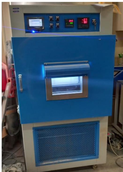
شکل ۲: دستگاه سیکل یخ و ذوب در بازه دمایی مختلف
