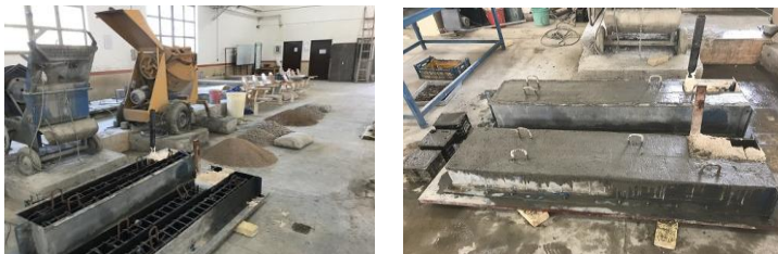
شکل 7- آرماتورگذاری و بتن ریزی نمونه های تیر
