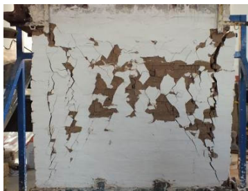
شکل ۲- الگوی ترک خوردگی و شکست نمونه W0
