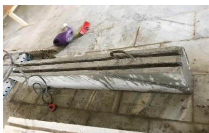
شکل 9- شیارهای ایجاد شده در وجوه فوقانی و جانبی تیرها
