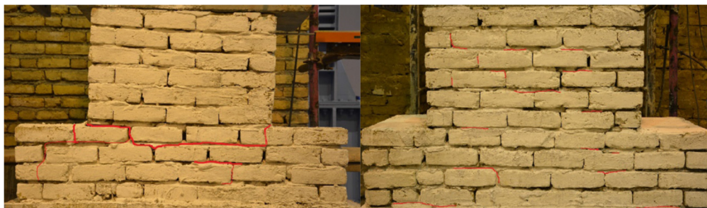
شکل ۱- کوتاه شدن مسیر ترک بعد از مقاوم سازی به روش تسلیح مغزه [۲]
