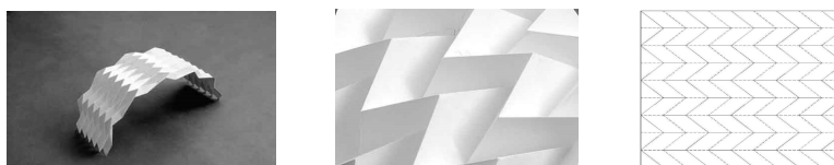
شکل ۸: الگوی میورا اوری (استخوان شاه‌ماهی) و نحوه تاخوردگی آن [۹]
