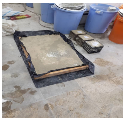
شکل ۴ دال و قالب‌های مکعبی بتن ریزی شده
