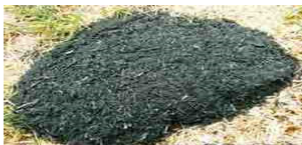
شکل ۷-خاکستر پوسته برنج آماده شده جهت استفاده در بتن
