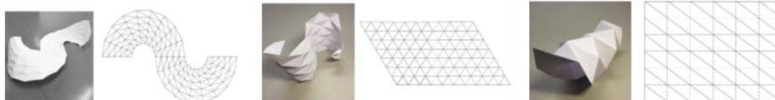
شکل ۷: الگوی اصلی تاخوردگی تکنیک قطری (راست)، فرم S شکل الگوی قطری (وسط) و فرم S شکل بی ثبات (چپ) [۱۲]
