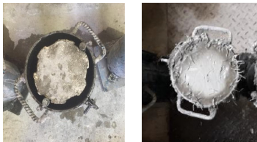
شکل ۱- شکل ستون قبل و بعد از تقویت با ژاکت بتنی
