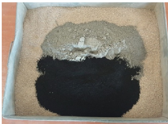
شکل ۱- الف: مخلوط سیمان، پودر لاستیک و ماسه قبل از اختلاط با آب
