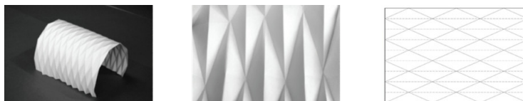
شکل ۴: الگوی یوشیمورا (الماسی) و نحوه تاخوردگی آن [۹]
