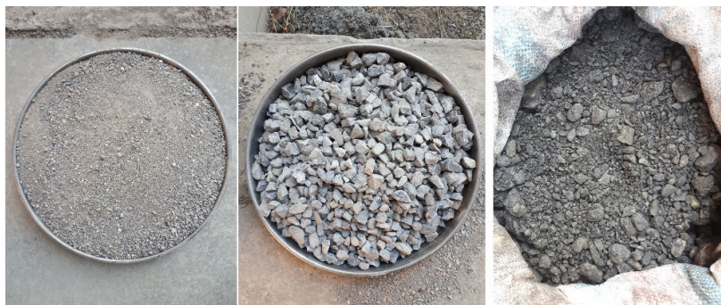
شکل ۲ - مصالح سنگی مصرفی (الف) باطله زغال سنگ (ب) درشت‌دانه طبیعی (ج) ریزدانه طبیعی
