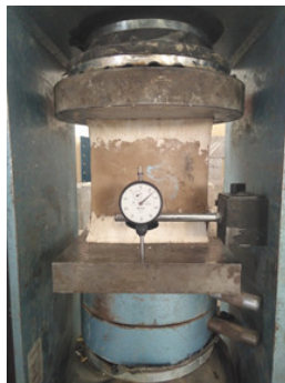
شکل ۲- نحوه انجام آزمایش فشاری روی یک نمونه خشت
