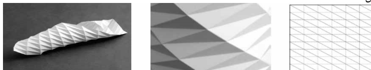
شکل ۶: الگوی مورب (قطری) و نحوه تاخوردگی آن [۹]
