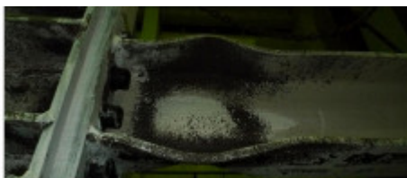
شکل ۳: مد شکست سازه SMRF، [۴]
