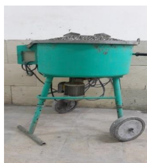
شکل ۱ مخلوط‌کن دیگ ثابت مورد استفاده در ساخت مخلوط‌ها
