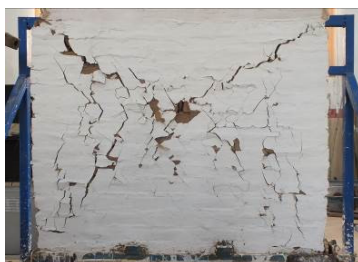
شکل ۴- الگوی ترک خوردگی و شکست نمونه W0.5
