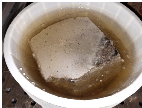
شکل ۲- قراردهی نمونه ترک خورده در محلول حاوی باکتری
