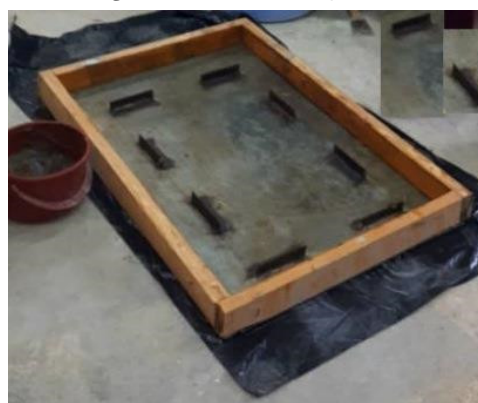
شکل ۳ موانع درون قالب ترک خوردگی
